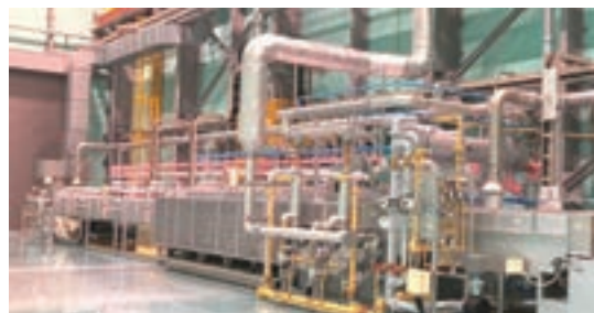
応力歪除去焼鈍炉(水口モータコア工場)
